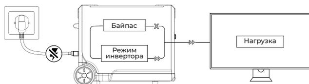
При отключении питания изделия от бытовой электросети ток перестает течь через цепь байпаса. Автоматически в течение 10 мс прибор переходит в режим работы инвертера. Продолжается подача электропитания на внешние устройства для обеспечения бесперебойной работы.
