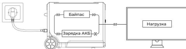
Электроэнергия поступает от электросети на подключенные внешние устройства (нагрузка) через встроенную цепь байпаса. Одновременно при этом идет процесс зарядки аккумуляторной батареи изделия. Суммарная мощность подключенных внешних устройств при работе изделия в режиме ИБП должна быть ниже 2500 Вт (на 220-240 Вт). Если суммарная мощность внешних подключенных устройств превышает рекомендуемую, то произойдет автоотключение прибора (срабатывает защита от перегрузки).
